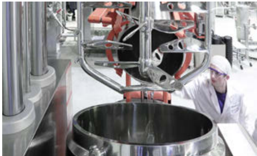
◀ Charging of our 150-l-mix-tank / Befüllung eines 150-L-Mischbehälters
